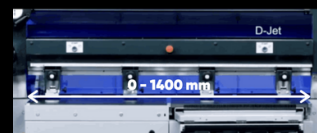
D-Jet Standard x-smer 0-1400 mm obdelovalna dolžina
